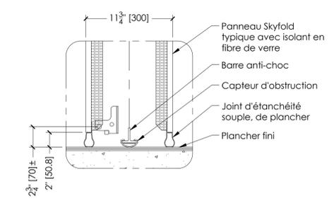
4 | DÉTAIL DU JOINT D'ÉTANCHÉITÉ AU PLANCHER
