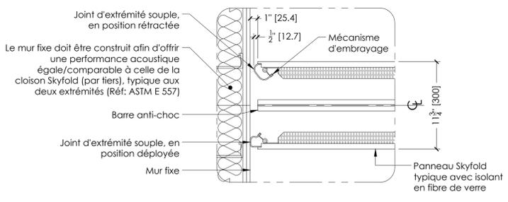
2 | DÉTAIL DU JOINT D'ÉTANCHÉITÉ AU MUR FIXE
