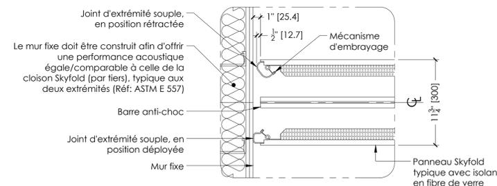
**2 | DÉTAIL DU JOINT D'ÉTANCHÉITÉ AU MUR FIXE**
