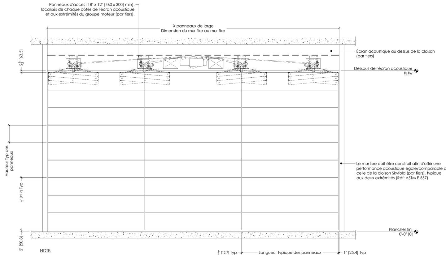
C | ÉLÉVATION - CLOISON ABAISSÉE
