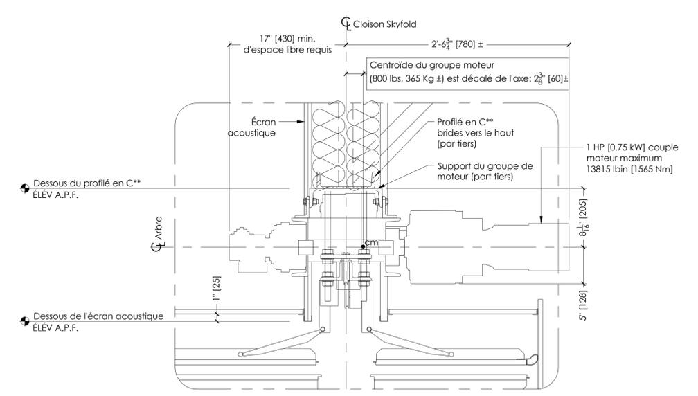
1 | DETAIL MÉCANIQUE SKYFOLD
