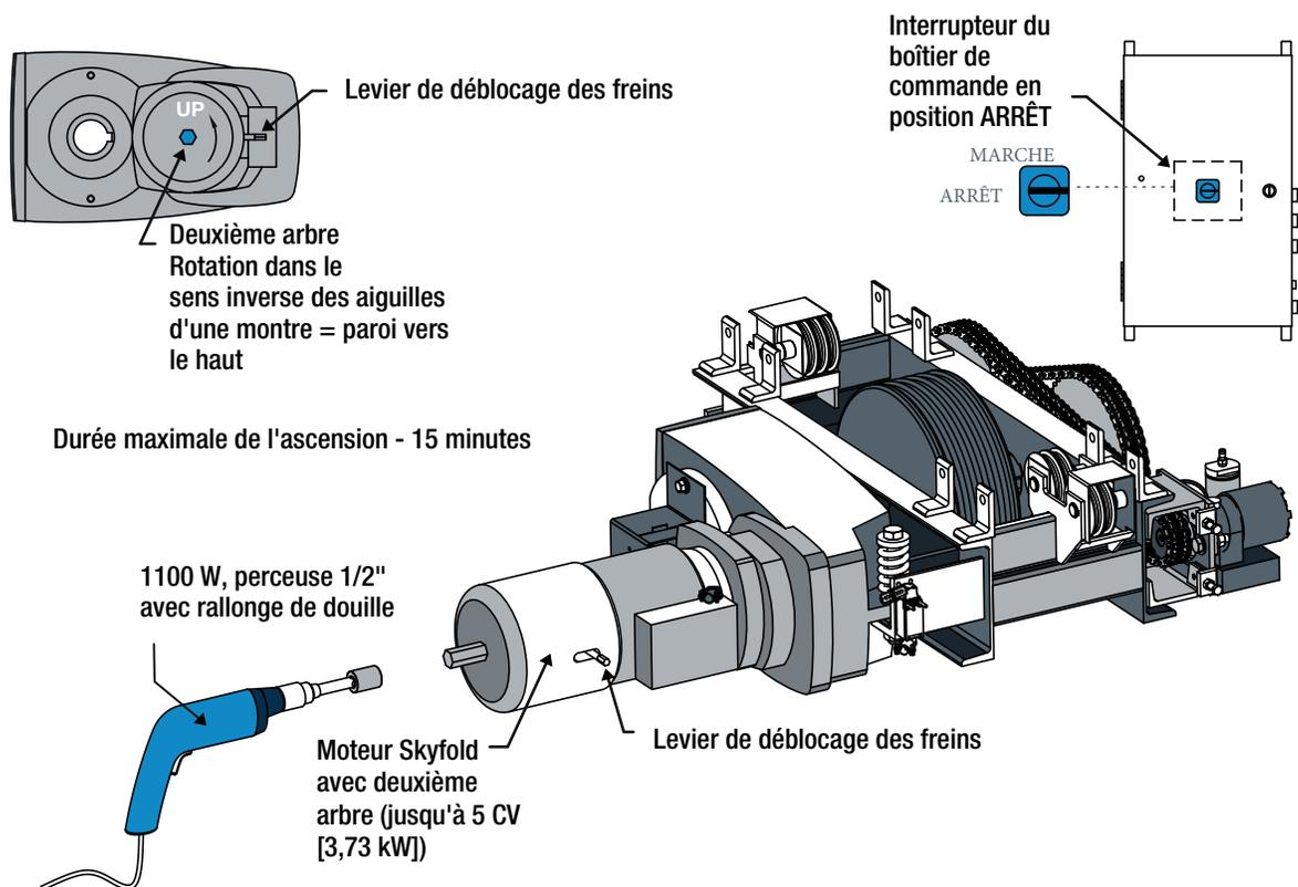
Dans le cas improbable où le mur Skyfold ne réagirait pas à l'interrupteur à clé, il peut désormais être actionné à l'aide d'une perceuse à usage intensif. Une extension de l'arbre a été ajoutée au moteur, ce qui permet une autre méthode pour élever et abaisser le mur. Cette fonction est désormais standard sur tous nos murs. Ce diagramme n'est fourni qu'à titre d'illustration. Veuillez vous référer aux procédures d'utilisation applicables pour des instructions complètes.
